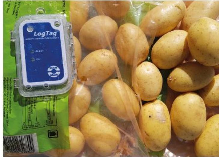
Grâce aux enregistreurs de données, l'évolution des températures et de l'humidité relative sont saisies de la récolte jusqu'à la mise en sac.
